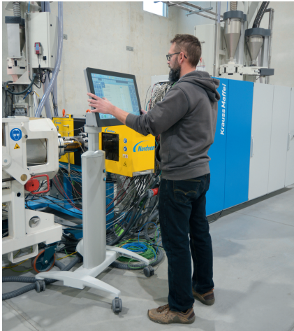
Auf Knopfdruck übernimmt QuickSwitch neben der Umstellung der Rohrdimension auch die Feineinstellung von Rohrwanddicke und Zentrierung. © KraussMaffei
